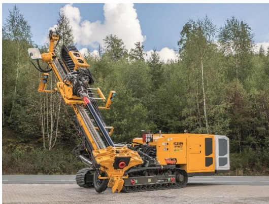
(3) 2022 präsentierte Klemm das weltweit erste batterie-elektrohydraulische Ankerbohrgerät für Überlagerungsbohrungen KR 806-3E.
